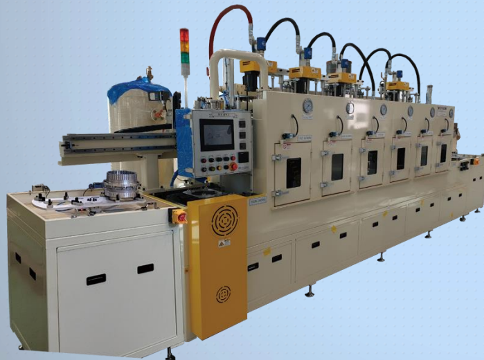
* 6조 자동 스프레이 세척기 * 스프레이세척 -> Ait Cut -> 스프레이 린스 1차, 2차 -> Air Cut -> 열풍건조 -> 자동배출
