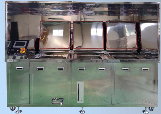
초음파세척 및 Air Bubble -> 초음파린스 -> Air Cut 및 열풍 건조
