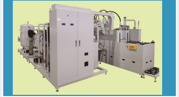
자동 세척기 후면부(전기제어부, Filtering System, Air Tank부)
